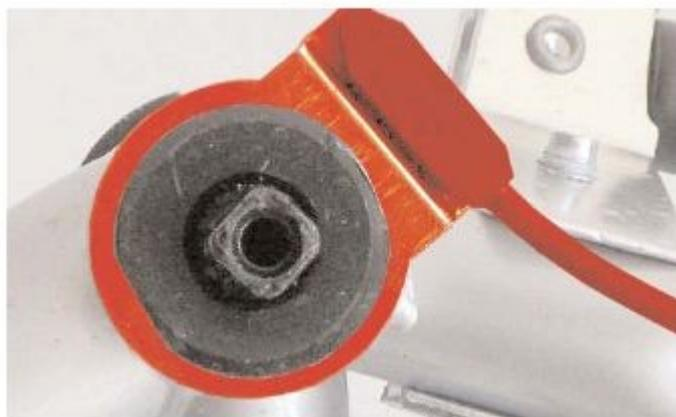
fate scivolare la ruota magnetica in modo che i magneti siano di fronte al sensore,
