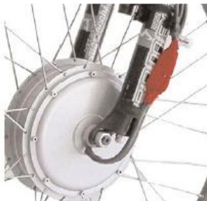
Il motore è collegato! Collegate i cavi della manopola dell'acceleratore, dei freni taglia-contatto, del sensore pedalata e quindi della batteria. Fatte correre il cavo d'alimentazione della batteria lungo il tubo superiore del telaio fissandolo con i collari di plastica forniti. Installate la borsa porta batteria su porta bagagli, e prima di collegare le batterie, controllate bene che tutto sia fissato, stretto e collegato correttamente.
