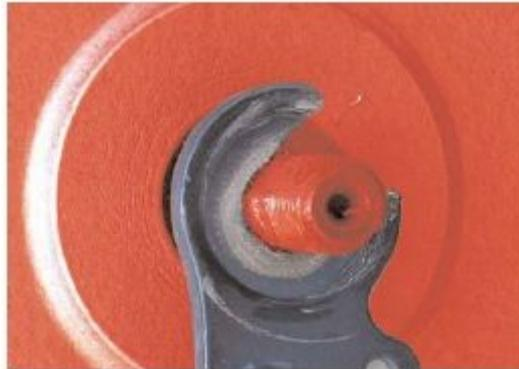
**QUESTO È MOLTO IMPORTANTE!** Se l'asse non è installato correttamente rischierà di slittare quando il motore sarà in funzione e questo potrebbe danneggiare i cavi del motore.
