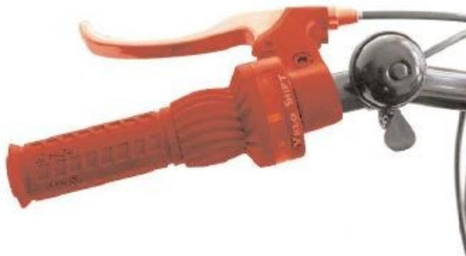
2) installate le nuove leve dei freni "taglia contatto", quindi l'impugnatura del variatore di velocità (se necessario), stringete le viti BTR delle leve dei freni e dell'impugnatura d'acceleratore con le adeguate chiavi Allen.
